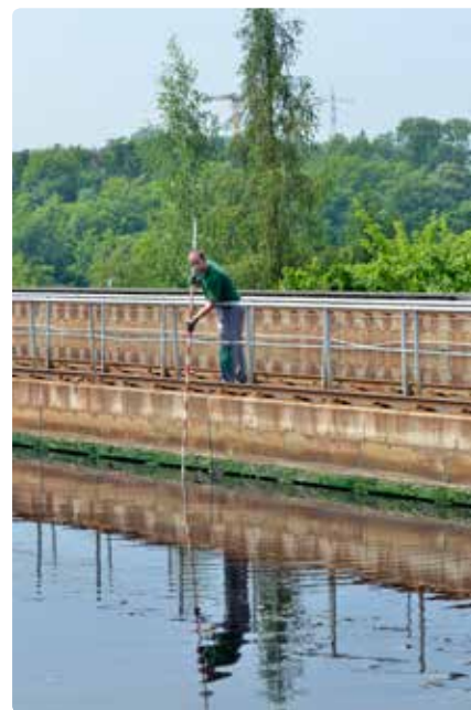
Der Kläranlagenmitarbeiter misst die Sichttiefe im Nachklärbecken der Kläranlage.
