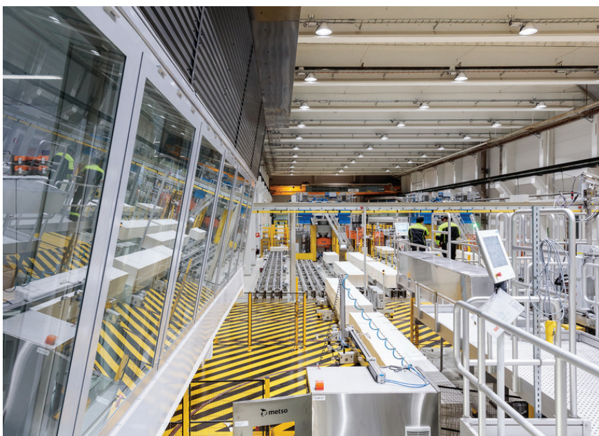
2015 valmistuneeseen sellutehtaan laajennus-investointiin kuului mm. uusi sellun kuivauskone. Paalauslinjoja on kaksi.
