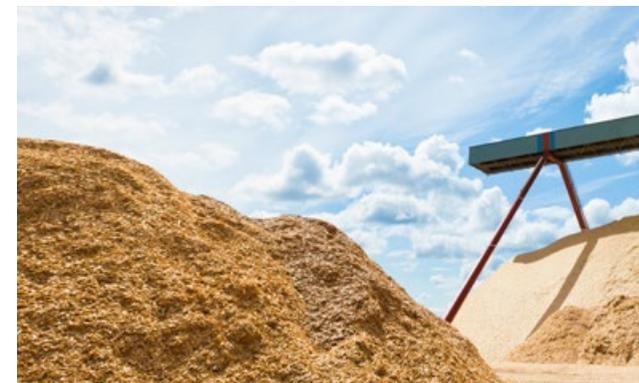
Le pin, l'épicéa, le bouleau et l'eucalyptus sont les matières premières utilisées pour produire de la pâte au sulfate. Le bois écorcé est réduit en copeaux et passé au crible avant que la cuisson ne commence. L'image montre le site d'entreposage des copeaux de pin, d'épicéa et de bouleau à l'usine d'UPM Kymi en Finlande.
