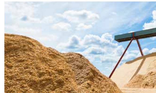
松木、云杉、桦木和桉木都是生产硫酸盐纸浆的原材料。剥皮后的木材将进行削片和筛选处理，之后转到制浆蒸煮过程。图中显示了芬兰UPM Kymi浆厂中存放的松木、云杉和桦木片。
