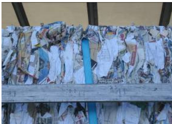
Abb. 13: Einschneiden des Zurrmittels in den Altpapierballen
