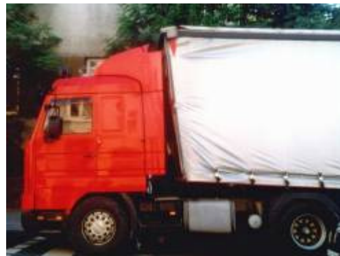
Abb. 6: Durch Ladungsverschub beschädigte Stirnwand
