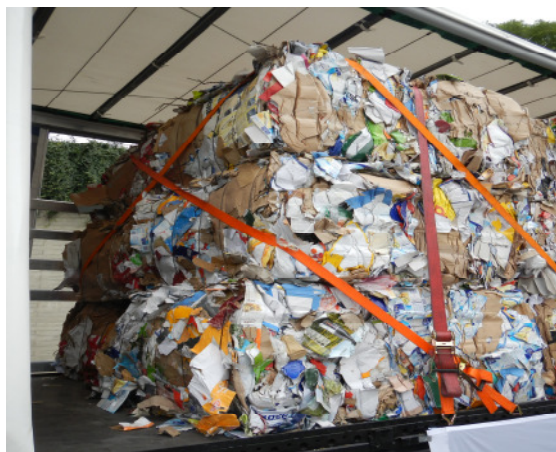
Abb. 14: Rückhalteverzurrung mit Rückhaltesicherung
