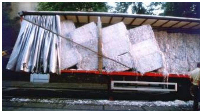
Abb. 5: Ladungsverschub nach einem starken Bremsmanöver
