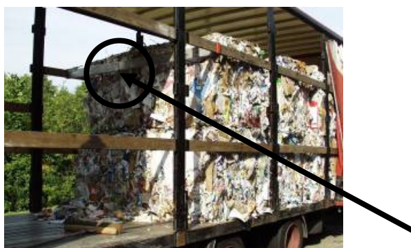
Abb. 16: Unzureichende Ladungssicherung nach vorne durch ein Klemmbrett als Sicherungsmittel
