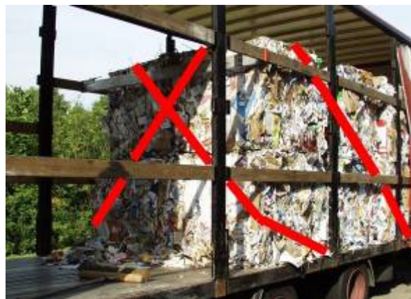
Abb. 15: Grafische Darstellung einer Rückhalteverzurrung. Das Klemmbrett ist entbehrlich. Es kann aber bspw. zur Gurtführung verwendet werden
