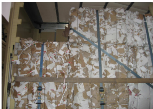
Abb. 8: Formschlüssige Beladung der ersten Lage Altpapierballen an die Stirnwand. Kopfschlinge am versetzten Stapelbeginn der oberen Lage
