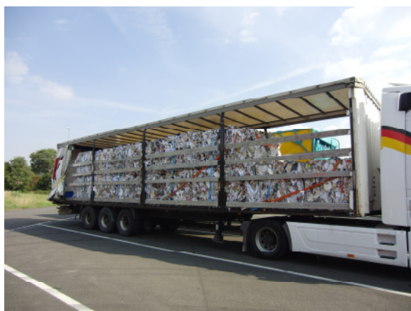
Abb. 3: Beispiel für ein Sattelkraftfahrzeug mit seitlicher Schiebepanzen
